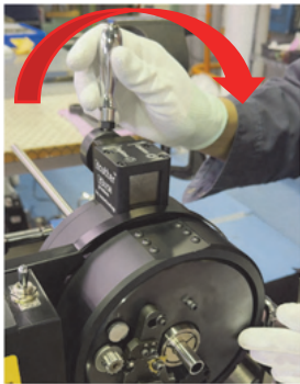
クランプレバー緩める(Loosen)
