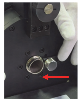
固定版を左へスライドし固定ネジを締める
